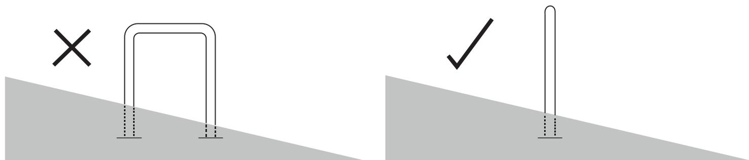
A zona de estacionamento para bicicletas deverá ser situada num local plano. Quando isto não for possível, os suportes deverão ser colocados na perpendicular ao plano inclinado, para evitar que as bicicletas deslizem.
